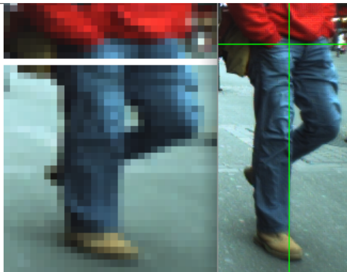
FIGURE 17 – Exemple de détection de l’axe torse/jambes sur la même image. Le code original de SDALF (à gauche) comportait une erreur que j’ai corrigé afin de rendre l’axe calculé plus fiable (voir à droite le résultat de mon code).
