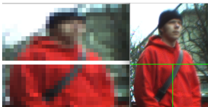
FIGURE 16 – Exemple de détection de l'axe tête/torse sur une image du set de données ETHZ1 (à gauche la détection du code de SDALF original, à droite l'axe horizontal représenté par mon code). L'axe détecté est plus bas que le cou car la fenêtre choisie empêche de commencer la recherche plus haut.
