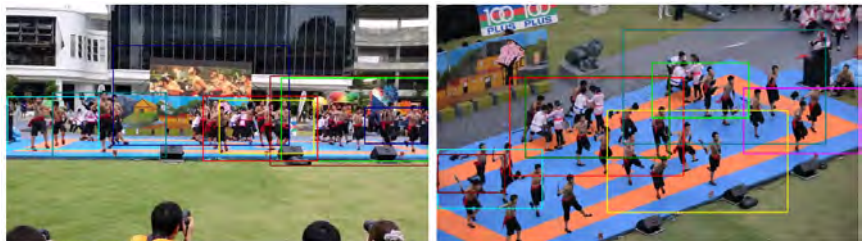
Résultat - Boîtes englobantes obtenues à partir d'une information 3D reprojétée dans l'espace 2D. Les boîtes englobantes de même couleur correspondent à un même objet d'intérêt.
