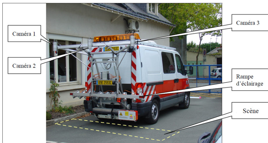
FIGURE 1 – Méthode actuelle de relevé de dégradations de surfaces de chaussées en France (illustration de [Ngu10]).
