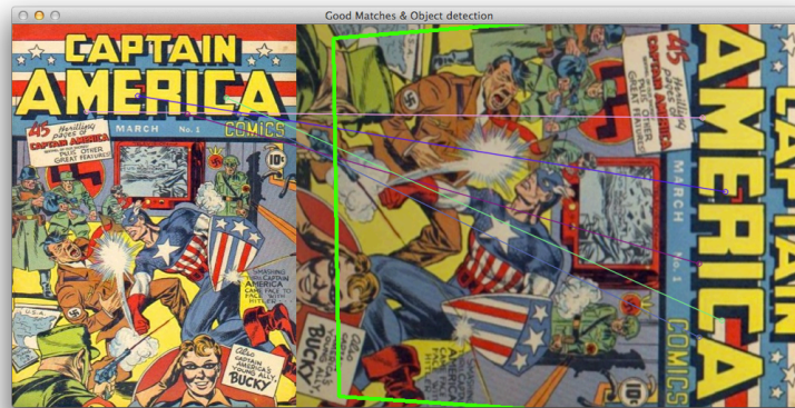
FIG. 13 : Un cas pathologique où tous les appariements sont corrects, mais l'homographie estimée est trop approximative car ces appariements sont situés sur la même ligne.
