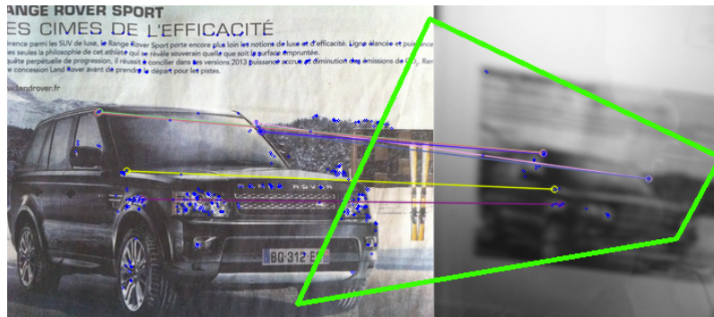
FIG. 19 : Impact du flou sur le calcul des appariements et l'estimation de l'homographie. Les points d'intérêt sont dessinés en bleu, les appariements représentés par des lignes, et le quadrilatère vert représente l'image des coins de l'image de référence par l'homographie estimée.
